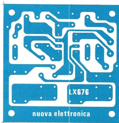
Fig. 6 Disegno a grandezza naturale del circuito stampato siglato LX.676 , necessario per la realizzazione di questo filtro, con il quale potrete misurare l'entità della distorsione su qualsiasi amplificatore o preamplificatore di BF.
