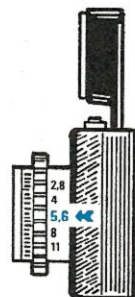
Fig. 9 Ammesso che la pellicola fosse una 100 ASA, dovremmo regolare il diaframma su f/5,6, se fosse invece una 400 ASA, con lo stesso diodo led acceso, dovremmo regolare il diaframma su f/11.
